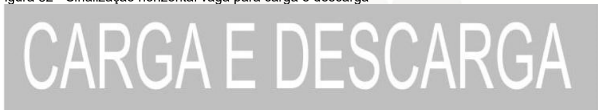
Figura 82 - Sinalização horizontal vaga para carga e descarga
