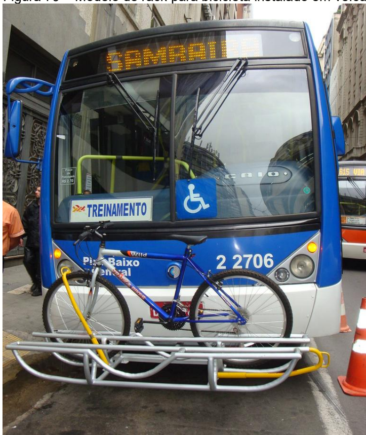
Figura 79 – Modelo de rack para bicicleta instalado em veículo de transporte coletivo em São Paulo
