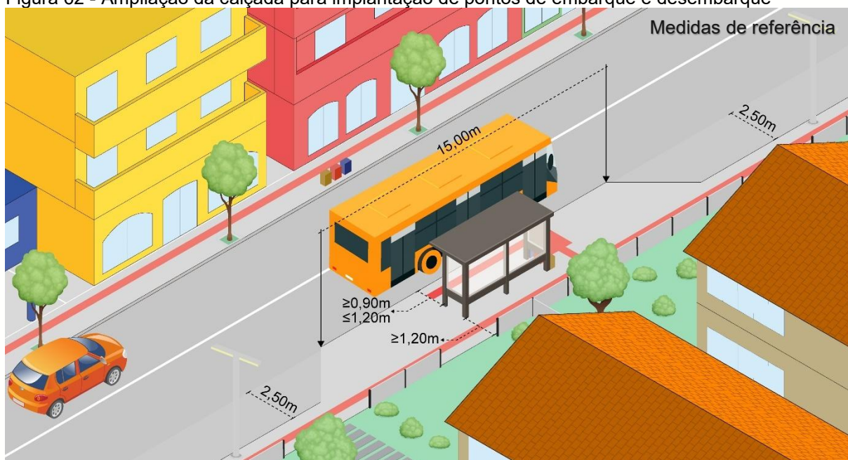
Figura 62 - Ampliação da calçada para implantação de pontos de embarque e desembarque
