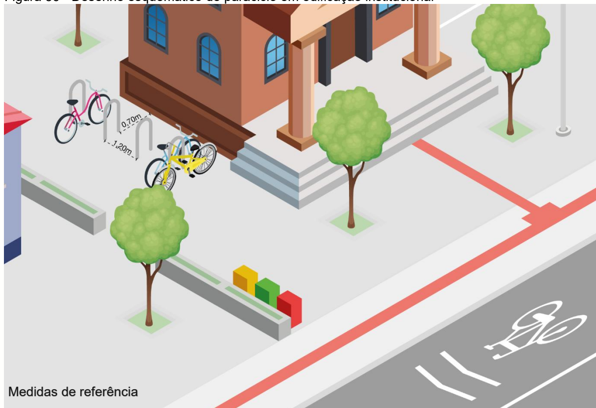
Figura 56 - Desenho esquemático de paraciclo em edificação institucional
