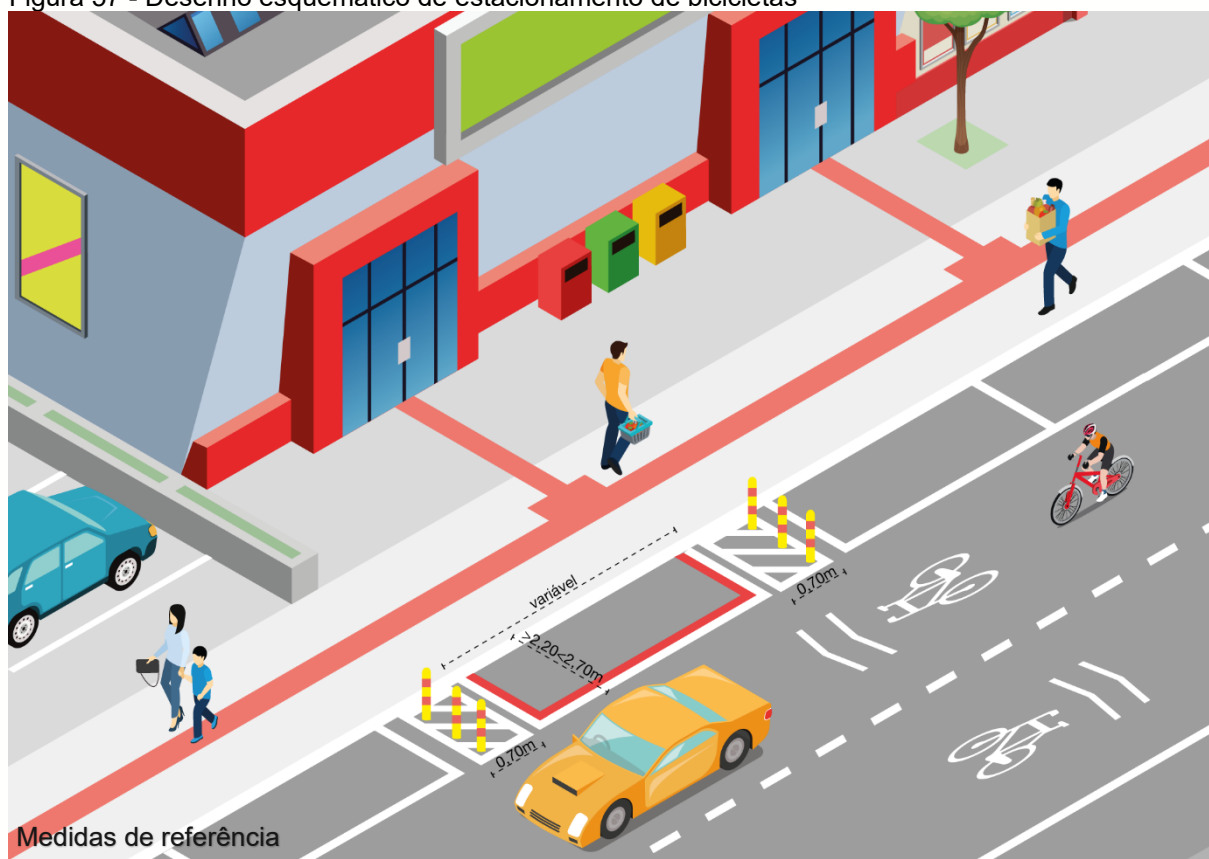
Figura 57 - Desenho esquemático de estacionamento de bicicletas
