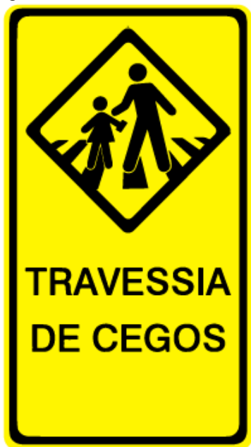
Figura 33 – Placa de advertência de A-33B, complementada com “Travessia de Cegos”
