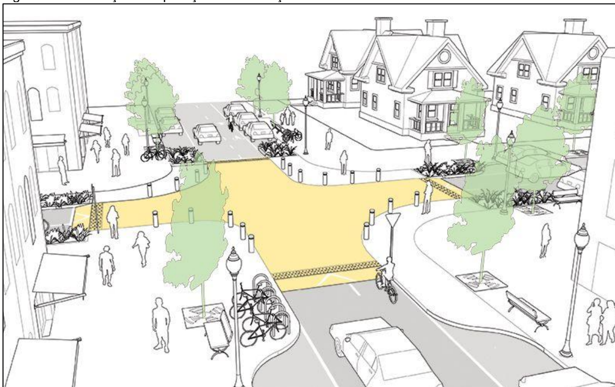
Figura 95 – Ilustração de aplicação de interseção elevada.
